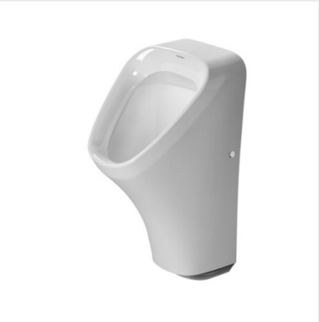
PISOÁR 300X340MM PRO BATERIOVÉ PŘIPOJENÍ, PŘÍTOK ZE ZADU, ODPAD VODOROVNÝ, BÍLÁ
